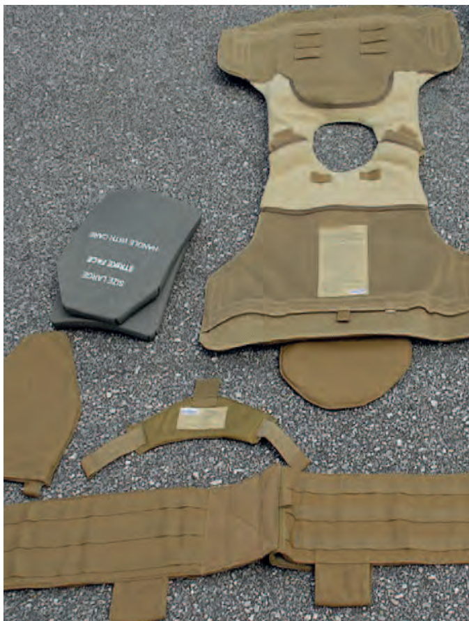
Figura 13.- Chaleco antibalas con relleno de hilo de araña. Ethan E. Rocke, United States Marine Corps.
